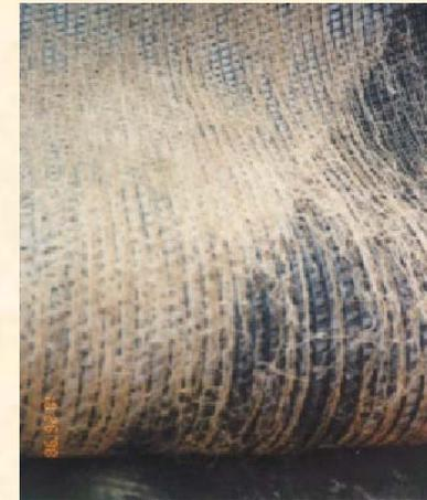
Geocompuesto drenante lleno de raíces. El espesor del suelo de cobertura era escaso
