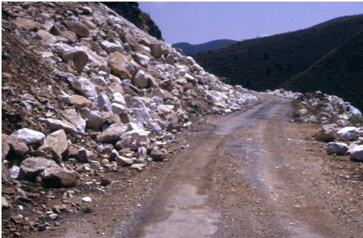
Foto 1.3. Segregación de los estériles rocosos.
