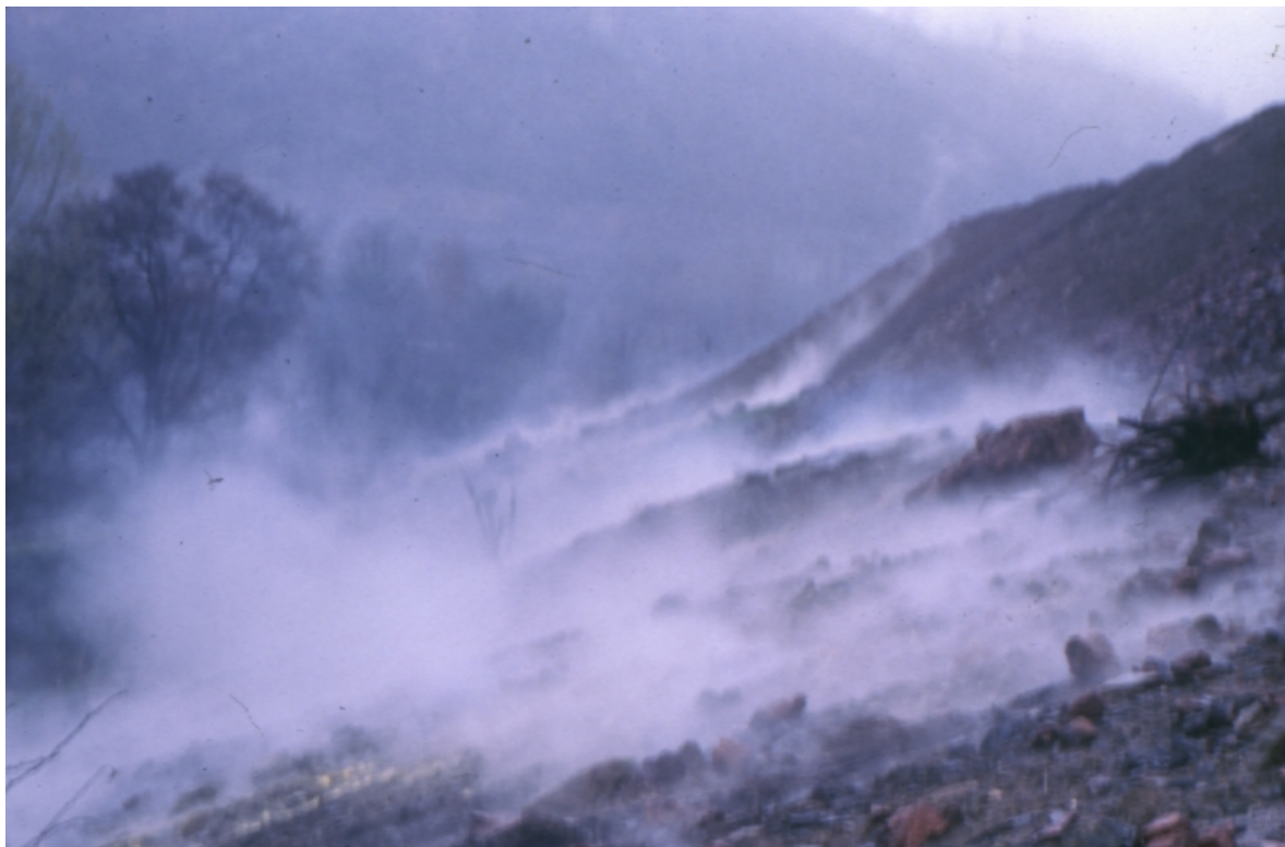
Foto 5.1. Escombrera de estériles carbonosos en ignición.
