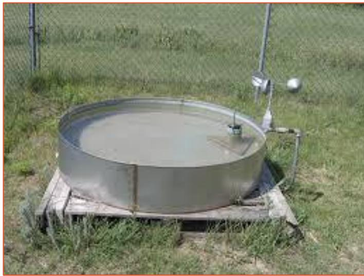
Fotografía 12.- Tanque de evaporación
