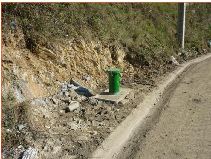
*Fotografía 9.- Pozo de control en el exterior de un vertedero para permitir la medición del nivel freático en el terreno y la toma de muestras de agua subterránea*
