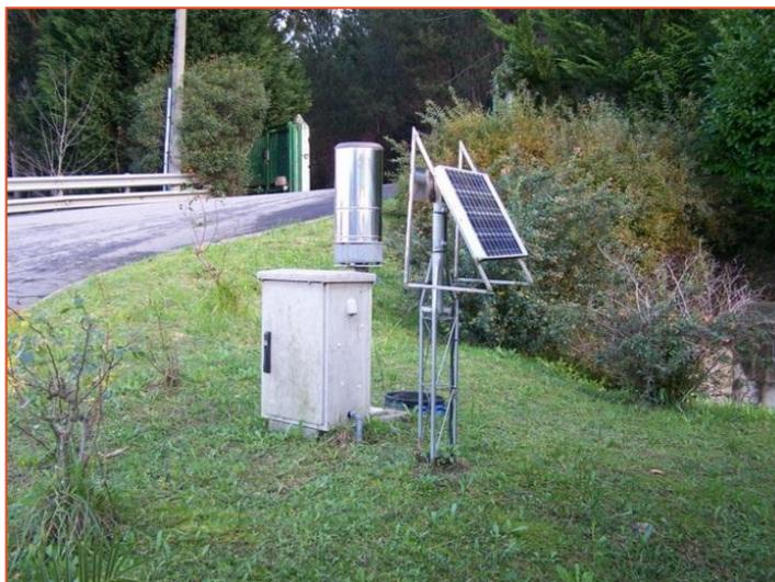
*Fotografía 4.- Observatorio con pluviómetro en un vertedero*
