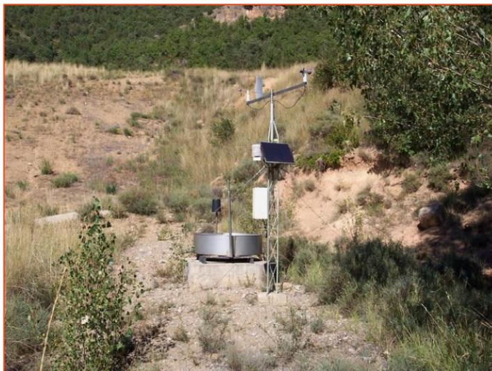
*Fotografía 13.- Tanque de evaporación en el observatorio meteorológico de un vertedero. Su posición es inadecuada (relieve circundante, árbol, altura respecto a la superficie)*
