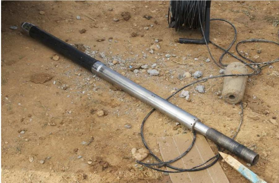
Penetrómetros (CPT - CPTu)
